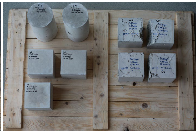
Figure 13 : a et b) Epreuves pour la détermination des résistances à la compression et à la traction par fendage.
