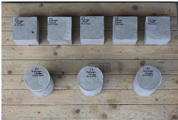
Figure 13 : a et b) Epreuves pour la détermination des résistances à la compression et à la traction par fendage.
