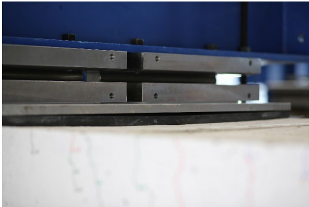
Figure 33 : Epreuve P 2.1 : irrégularités dans la zone de l'appui négatif.
