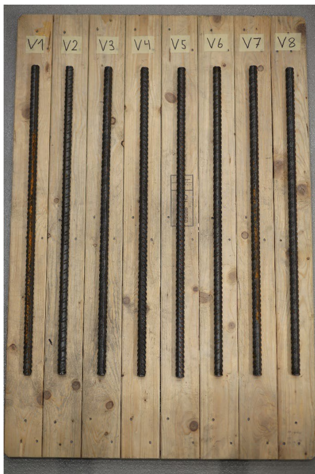
Figure 11 : Armature de flexion d= 20 mm, a) avant les essais de traction, b) après les essais de traction.
