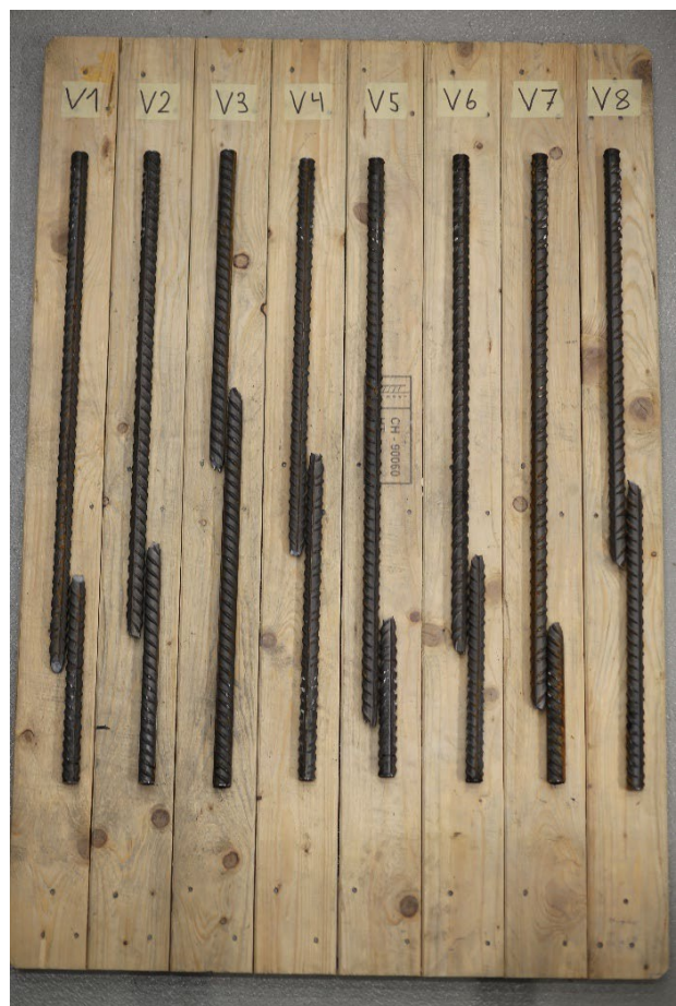
Figure 11 : Armature de flexion d= 20 mm, a) avant les essais de traction, b) après les essais de traction.
