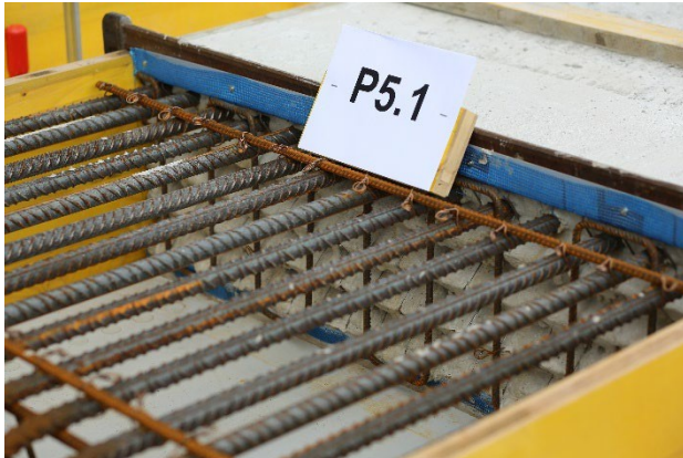
Figure 10 : a) Epreuve avant le bétonnage, b) Bétonnage de la première étape, c) Coffrage après le bétonnage de la première étape, d) Bétonnage de la deuxième étape.
