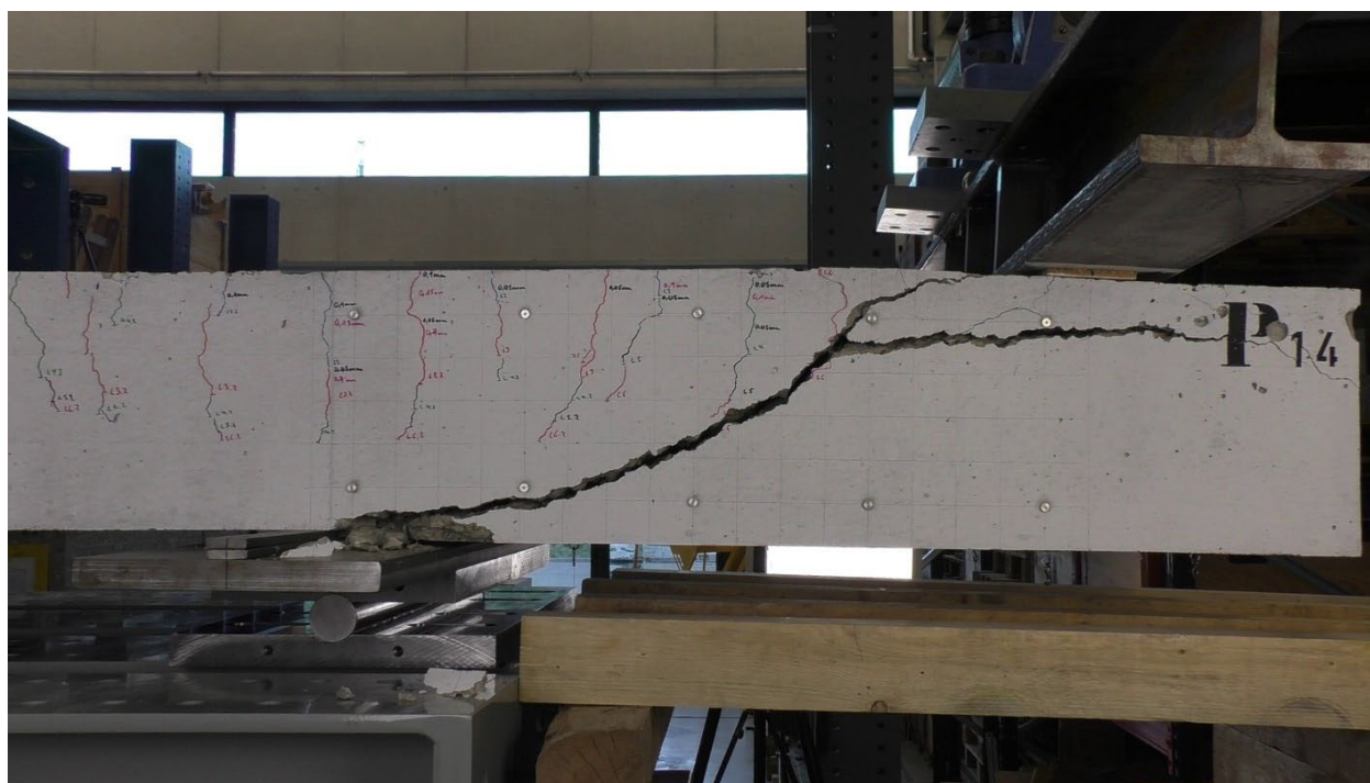
Figure 38 : Epruvette P 2.2 : fissure par effort tranchant après la fin de l'essai
