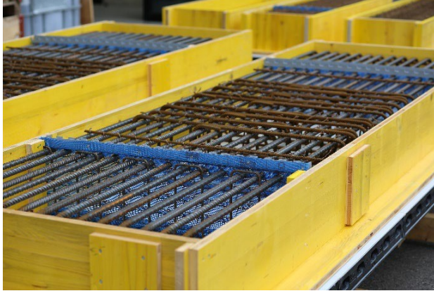
Figure 9 : a, b) Epreuve après la mise en place de l'armature et des éléments de coffrage.
