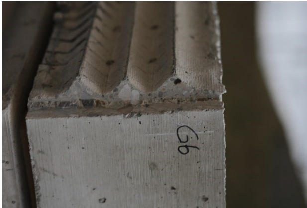
Bild 2: Gittertyp 6, a,b) nach dem Biegeversuch, c) Kornverteilung in den Nocken, d) vor dem Biegeversuch.
