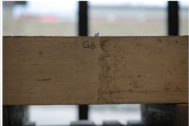
Bild 2: Gittertyp 6, a,b) nach dem Biegeversuch, c) Kornverteilung in den Nocken, d) vor dem Biegeversuch.
