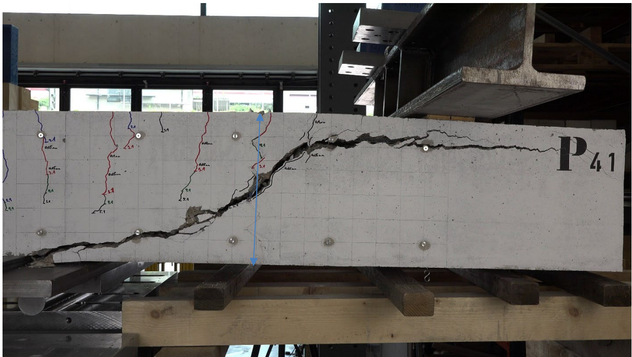
Bild 31: Prüfkörper P 4.1: Querkraftriß nach Versuchsende.
