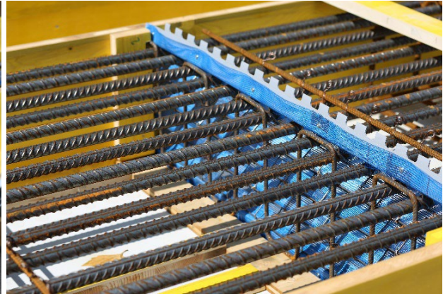
Bild 9: a, b) Prüfkörper nach dem Einbringen der Bewehrung und den Abschalungselementen.
