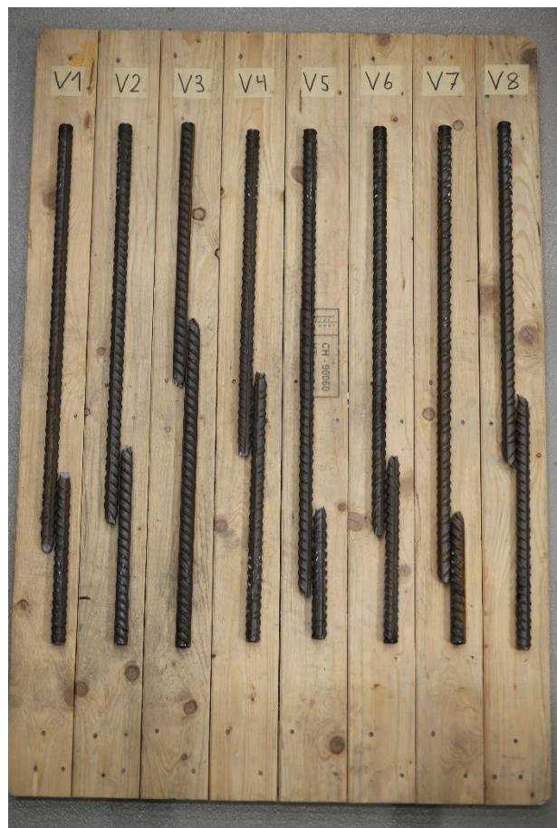
Bild 11: Biegebewehrung d = 20 mm, a) Vor den Zugversuchen, b) Nach den Zugversuchen.
