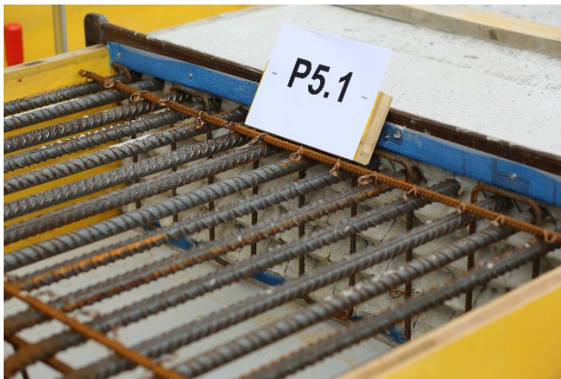
Bild 10: a) Prüfkörper vor dem Betonieren, b) Betonieren der ersten Etappe, c) Abschalung nach dem betonieren der ersten Etappe, d) Betonieren der zweiten Etappe.
