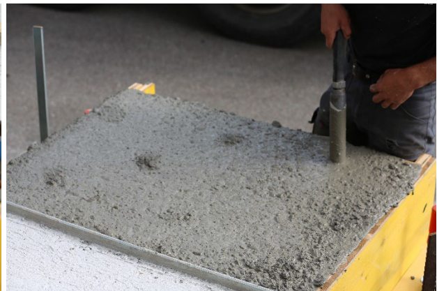
Bild 10: a) Prüfkörper vor dem Betonieren, b) Betonieren der ersten Etappe, c) Abschalung nach dem betonieren der ersten Etappe, d) Betonieren der zweiten Etappe.
