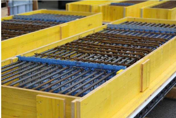
Bild 9: a, b) Prüfkörper nach dem Einbringen der Bewehrung und den Abschalungselementen.
