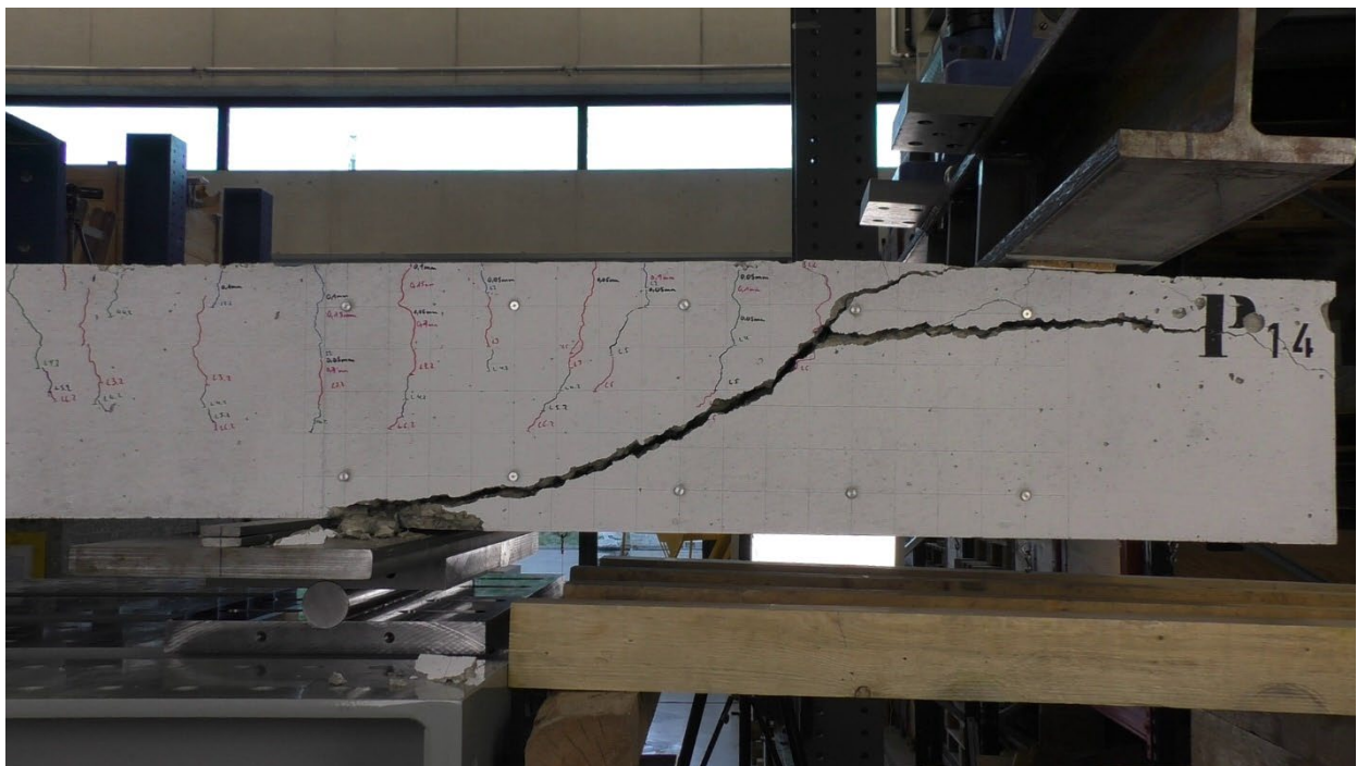
Bild 38: Prüfkörper P 2.2: Querkraftriß nach Versuchsende
