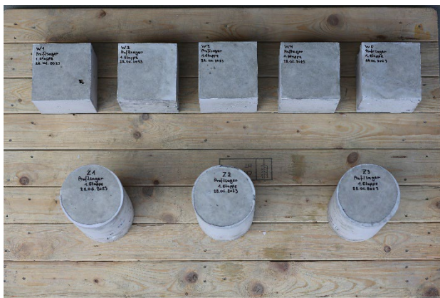
Bild 13: a und b) Prüfkörper zur Ermittlung der Druck- und Spaltzugfestigkeiten.
