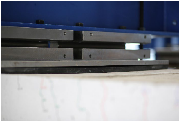
Bild 33: Prüfkörper P 2.1: Unebenheiten im Bereich des negativen Auflagers.
