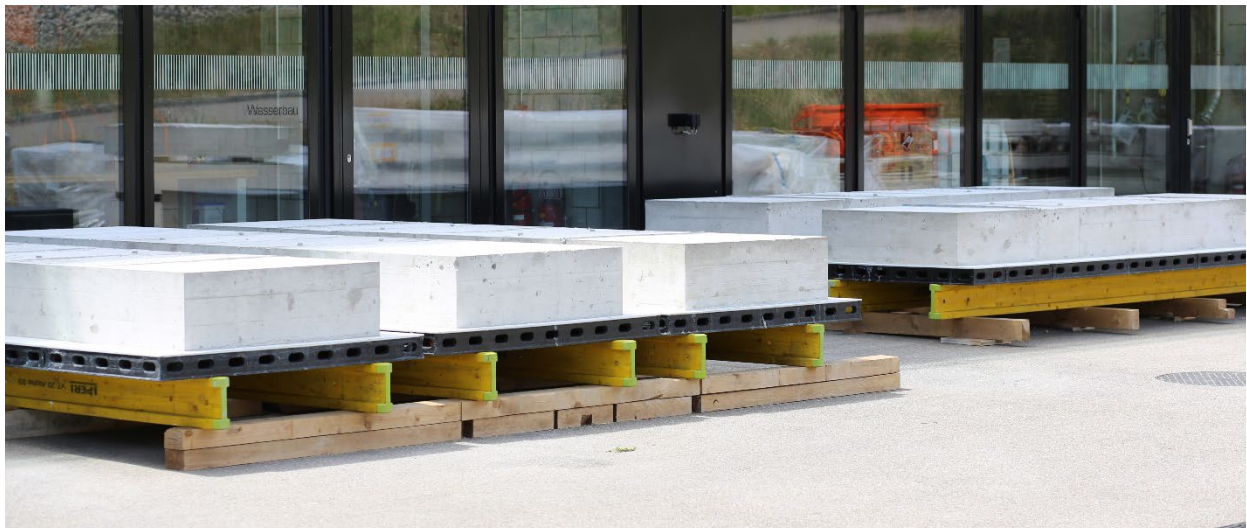
Bild 6: Prüfkörper nach dem Entfernen der seitlichen Abschalungen.
