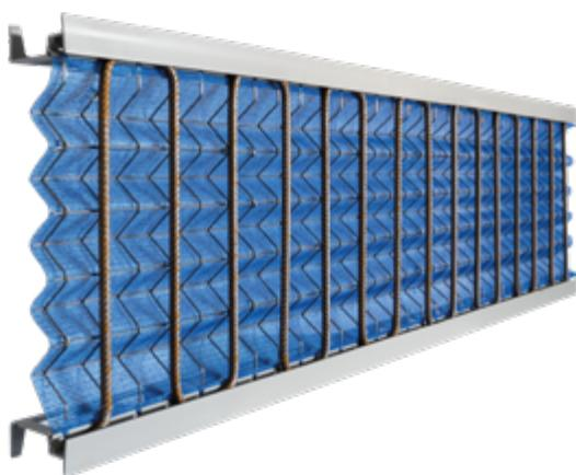
Les différences de hauteur, par exemple dans les pentes, sont compensées de manière flexible à l'aide d'un profilé enfichable. Celui-ci permet une augmentation temporaire de la hauteur pouvant aller jusqu'à 5 cm et est retiré avant la deuxième étape de bétonnage.
